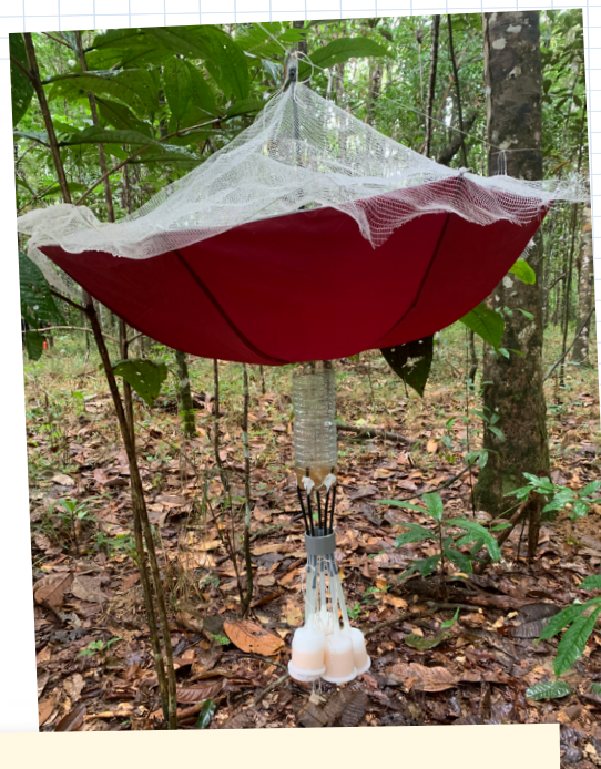
Figura 1: Diagrama e foto de um coletor de água de lavagem da chuva feito com materiais comuns.
