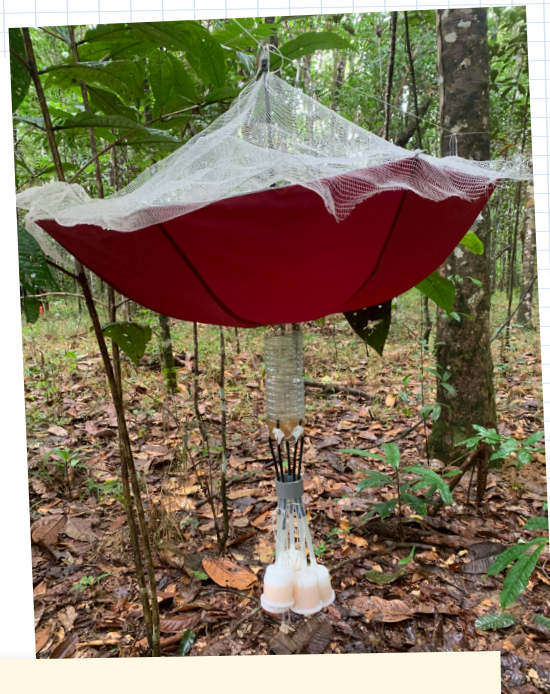
Figure 1: Un diagramme et une photo du collecteur d'eau de pluie fait de matériaux communs.
