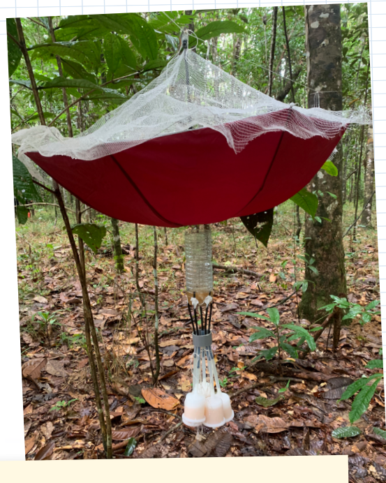
Figura 1: Un diagrama y una foto del colector de agua de lluvia fabricado con materiales comunes.
